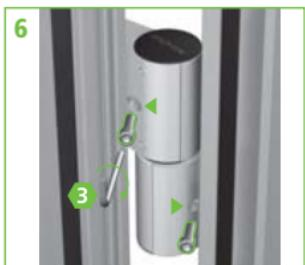
NL 4 Samengevoegde scharnierdelen op profiel plaatsen en door minstens twee profielwanden vastschroeven (20 Nm). Alternatieve bevestigingswijze: bevestigingsplaat (20–25 Nm). 5 Afdekplaatjes vastklikken, afdekdop aanbrengen. 6 Afdekplaatjes vastzetten aan de achterzijde.
