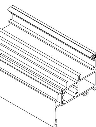
Commencer à insérer le joint 224310 au milieu de de l'ouvrant. Une fois le montage terminé, coller les extrémités des joints à la colle art.-N° 298074.
