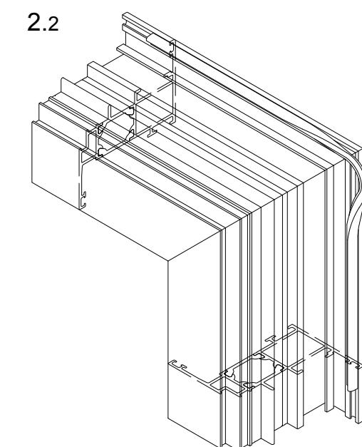
Die Dichtung ist leicht nach aussen zu verdrehen mit den Fingern zu fixieren und ca. 20 mm nach der Flügelcke in die Profilnute einzudrücken.
