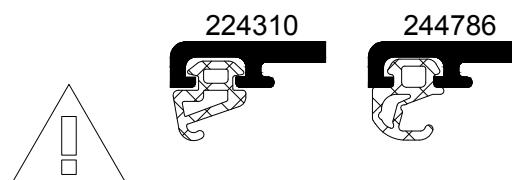
In Fenster mit verdeckt liegendem Beschlag können die Anschlagdichtungen 224310 und 244786 eingesetzt werden.
